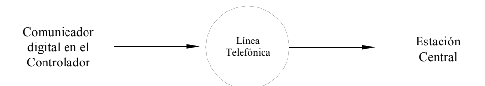
Configuración del Sistema de Señal de Transmisión de Línea Única
