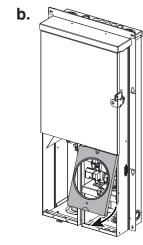
C. Effectuer le raccordement à la barre de neutre en passant par l'ouverture près de la cosse de terre dans le compartiment de câblage.
