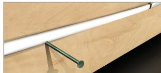
Dentro de las paredes desde clavos, tornillos o grapas que inadvertidamente pasen a través de los cables
