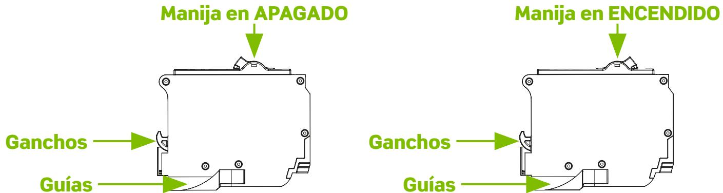
4. Si el interruptor del circuito derivado FTPE se puede poner en la posición de ENCENDIDO y la ventana de la manija es verde, está funcionando perfectamente.
