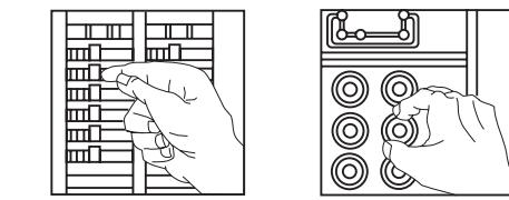
Une fois cette vérification faite, enficher le même appareil dans l'autre sortie afin de s'assurer que l'alimentation y est aussi coupée. Dans le cas contraire, on doit abandonner les travaux et faire appel à un électricien qualifié.
