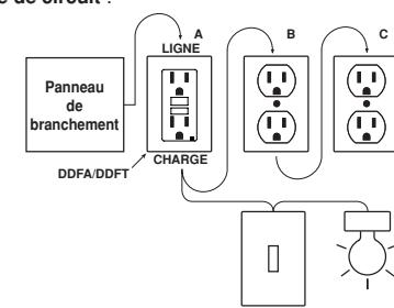
La prise à DDAA/DDFT doit toujours être installée à la position A. Toutes les sorties de la dérivation protégée, y compris celles d'éclairage et d'autres prises, doivent être raccordées sur côté charge du DDAA/DDFT.
