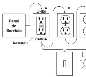
Siempre coloque este contacto ICFA/ICFT de circuito derivado en la posición A. Todos los contactos de la rama protegida, incluyendo iluminación y salidas de los receptáculos se deben conectar en el lado de la carga de la ICFA/ICFT.
