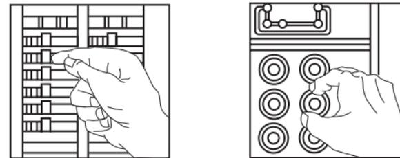
Luego, conecte y ENCIENDA la lámpara o el radio en la otra salida del receptáculo para asegurarse que la corriente está DESCONECTADA en ambas salidas. Si la corriente no está DESCONECTADA, pare el trabajo y contacte con un electricista para completar la operación.
