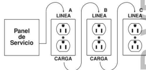
Colocar el ICFT en la posición A también proveerá protección a los "lado de carga" receptáculos B y C. Si coloca el ICFT en la posición C no proveerá protección a los receptáculos A o B. Recuerde que los receptáculos A, B y C pueden estar en diferentes habitaciones.
