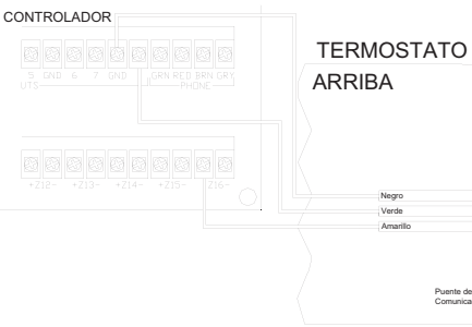
Figura 9 – Conexiones al Sistema de Control Doméstico Leviton
