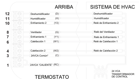
Figura 7 – Conexiones para el termostato de la bomba de calor
