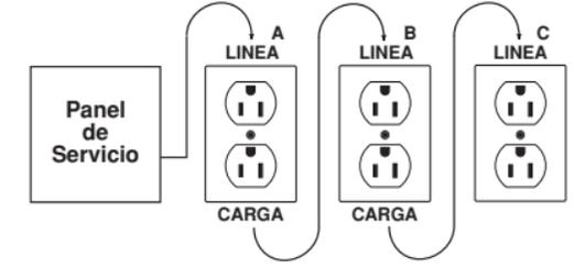
Colocar el ICFT en la posición A también proveerá protección a los "lado de carga" receptáculos B y C. Si coloca el ICFT en la posición C no proveerá protección a los receptáculos A o B. Recuerde que los receptáculos A, B y C pueden estar en diferentes habitaciones.
