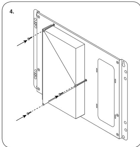
Fije la placa de retención triangular usando los tornillos provistos.
