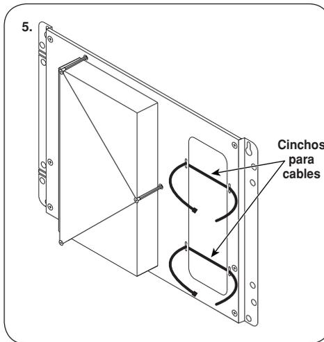
Instale los ataduras para sujetar los cables en el POEMP-KIT como se muestra.
