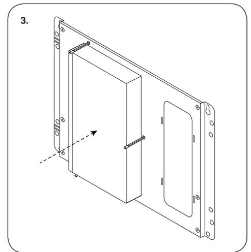
Coloque interruptor PoE de 8 puertos POENS-8PT sobre el kit POEMP-KIT de manera que las patas de goma colocadas en el paso 1 hagan contacto con el POEMP-KIT como se muestra (La etiqueta de identificación de producto para el POENS-8PT debe quedar de frente a usted).
