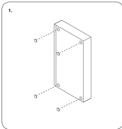
Coloque las 4 patas de goma proporcionadas con el kit POEMP-KIT en la parte superior de la caja del interruptor PoE de 8 puertos POENS-8PT como se muestra.
