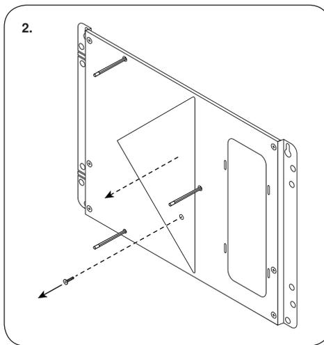
Retire el tornillo que sujeta la placa de retención triangular (*conservar este tornillo para el paso 4*).
