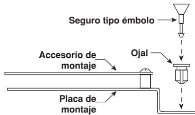
Inserte un ojal de plástico en cada uno de los cuatro orificios de la placa de montaje. Inserte uno de los seguros de plástico tipo émbolo en cada uno de los ojales.
