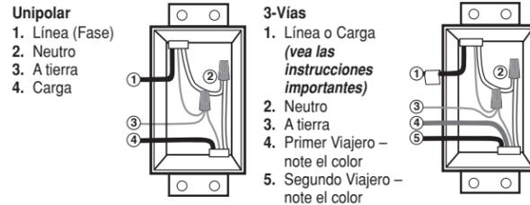
**¡IMPORTANTE:** Para aplicaciones de 3-Vías, note que uno de los tornillos terminales del interruptor viejo que se ha sacado es de color diferente (Negro) o marcado Común. Marque ese conductor con cinta aislante e identifíquelo como común (Línea o Carga) en el atenuador y en el remoto de la caja de pared.
