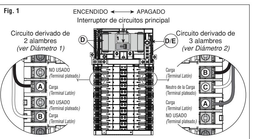
descubra las lengüetas de la terminal presionando hacia abajo las pestanas de la cubierta. Con ayuda de un destornillador de cabeza plana, afloje la lengüeta de la terminal e inserte los cables de energía de la carga. Una vez insertados, apriete las lengüetas de la terminal al torque adecuado (vea la Figura 6 y la tabla de Terminaciones) y cierre las cubiertas de la lengüeta de la terminal.
