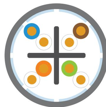
SECÇÃO TRANSVERSAL DO CABO U/UTP COM FITA DE FOLHA DESCONTÍNUA
