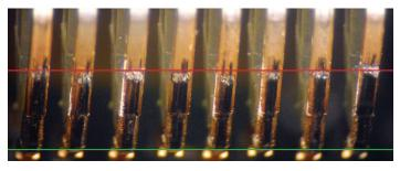
**Línea roja** = Punto en el que se produce daño a causa de la desconexión PoE+ mientras está alimentado.
