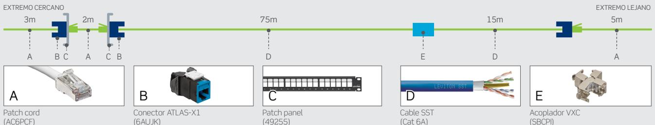
Nota: Los canales instalados para soportar aplicaciones de distancias extendidas deben tener longitudes de cables SST horizontales que permitan un máximo de 10 m de patch cords y que no excedan las longitudes máximas de canales en la tabla 2 para la velocidad de Ethernet y el nivel de alimentación PoE que se soportarán.
