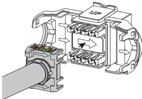
3. Tout en maintenant le gestionnaire de fils préparé contre l'arrière du connecteur et en alignant les flèches, fermer les portes du connecteur pour le raccorder au câble.
