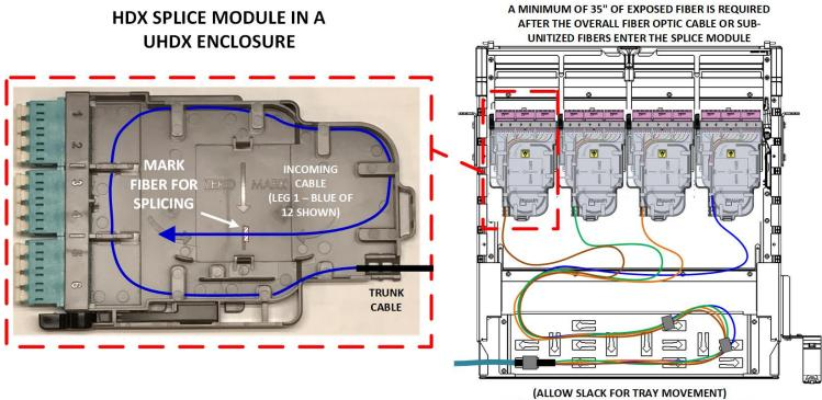
(ALLOW SLACK FOR TRAY MOVEMENT) 20 INCHES MINIMUM FROM LAST TIE DOWN POINT
