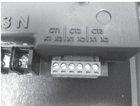
Bloque de Terminales del TC Colocado
