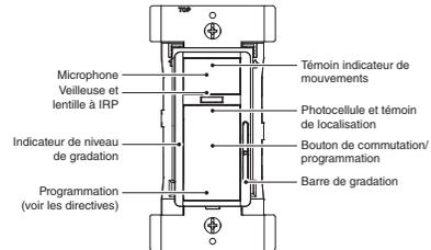
8. On peut ajouter des détecteurs dans la pièce afin de créer des systèmes à trois, à quatre ou à plusieurs voies. Les dispositifs peuvent être reliés les uns aux autres de façon à commander la pièce ensemble, en étendant du même coup la couverture offerte. Il est facile de former de tels systèmes pouvant compter jusqu'à cinq dispositifs grâce à la technologie P2P (Push to Pair) de Leviton.
