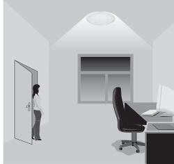
Si la lumière ambiante est insuffisante, les luminaires s'allument à la détection de mouvements.
