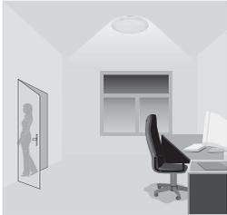
Une fois les lieux vides et le délai de maintien écoulé, les luminaires se tamisent à l'intensité de veille si le niveau d'éclairage ambiant se trouve sous le seuil choisi.
