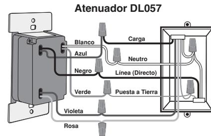
3. Restablezca la energía y pruebe la operación de ENCENDIDO/APAGADO. La luz de localización debe estar ENCENDIDA cuando la potencia del interruptor esté APAGADA.
