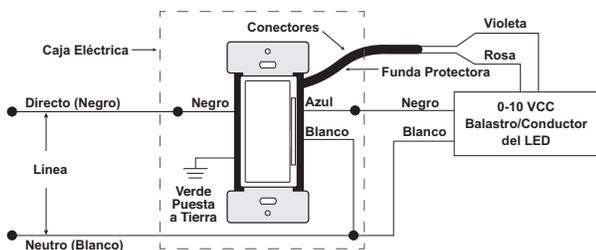
2. Coloque con cuidado los cables y su dispositivo dentro de la caja de pared y fije con los tornillos suministrados.
