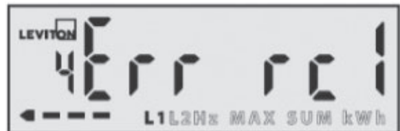
Pantalla de Error que muestra un error de instalación de Corriente Inversa en la Línea 1
