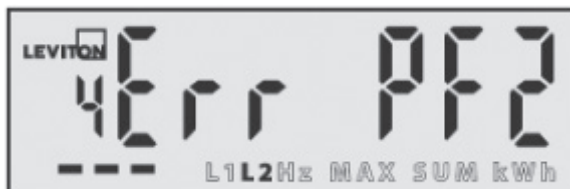
Pantalla de Error que muestra un error de instalación del Factor de Potencia en la Línea 2
