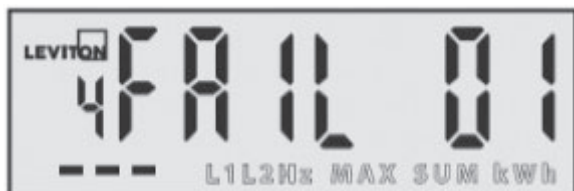
Écran montrant un code de défaillance (réparation à l'usine requise)
