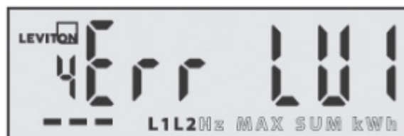
Écran montrant une erreur d'installation (basse tension) sur les lignes 1 et 2
