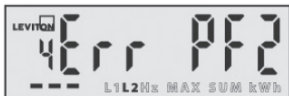
Écran montrant une erreur d'installation (mauvais facteur de puissance) sur la ligne 2
