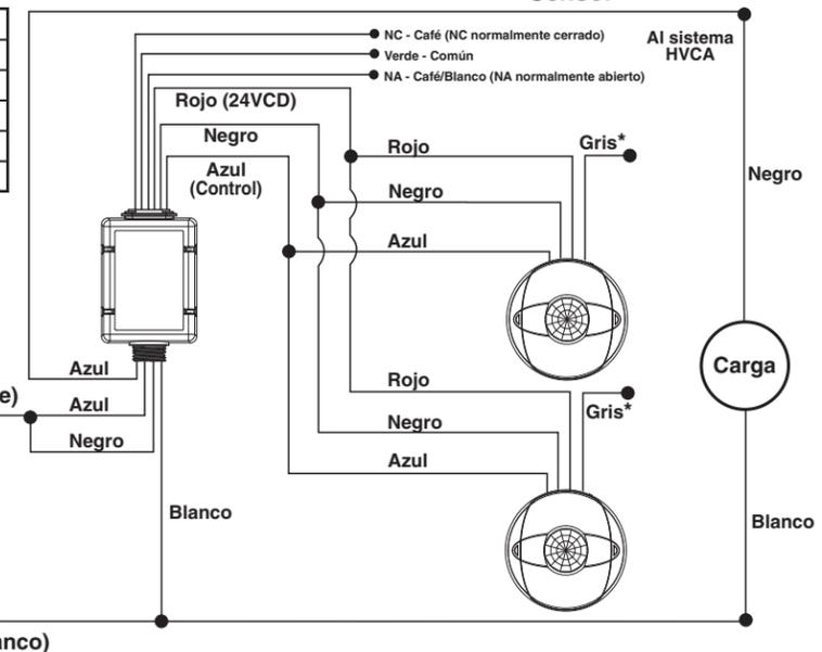
\*NOTA: Cuando use las funciones de la Fococélula, conecte el conductor Gris del sensor al conductor Azul del equipo de alimentación. No use el conductor Azul del sensor.
