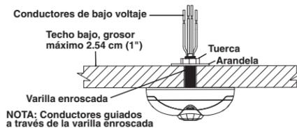
NOTA: Conductores guiados a través de la varilla enroscada
