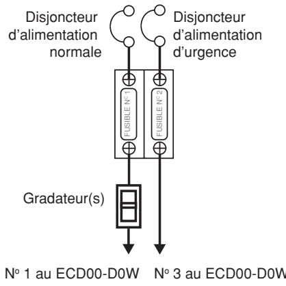
**2b.** Exemple 2 (fusibles installés du côté charge du gradateur) : ici, un kit de fusibles est requis pour chaque commutateur ECD00-D0W.
