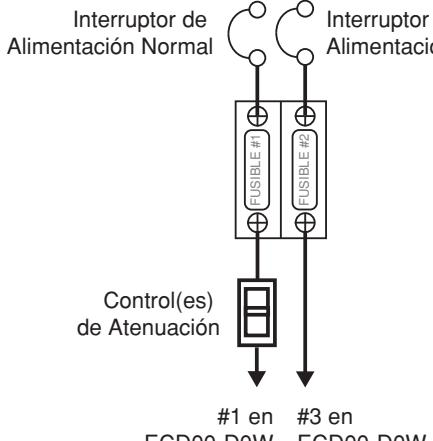
**2b.** Cableado ejemplo 2 - El fusible se instala en el lado de la carga del control de atenuación. De acuerdo con este método, es necesario un ECD00-FUS para cada ECD00-D0W.
