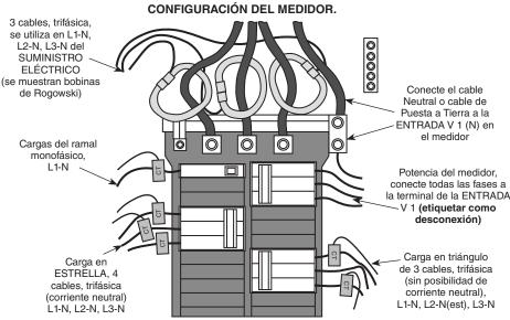
NOTA: La serie del medidor VerifEye utiliza la terminal NEUTRA como referencia del voltaje. Para sistemas sin un conductor neutral, Leviton sugiere conectar un cable de puesta a tierra a esta terminal. Si la terminal neutral se deja abierta, las mediciones de L-L serán exactas, pero las mediciones L-N podrían no ser simétricas. Si un cable de puesta a tierra se conecta a la terminal NEUTRAL. <2mA fluirá hacia el cable de puesta a tierra
