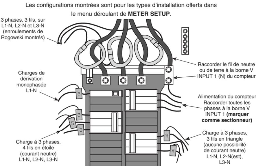
**REMARQUE :** Les compteurs VerifEye<sup>MD</sup> se servent de la borne NEUTRAL comme référence de tension. Dans les systèmes dépourvus de conducteur de neutre, Leviton suggère de connecter un fil de terre à cette borne. Si elle reste ouverte, les mesures L-L seront exactes, mais les mesures L-N pourraient être asymétriques. Si un fil de terre y est raccordé, un courant de < 2 mA passera dedans.
