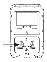
4. Retire el enchufe impermeable de la entrada del cable.
