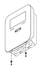
Retire el Panel de Acceso al Cableado. Utilice un destornillador de punta plana para desbloquear los pestillos y retire el panel.
