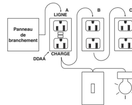
La prise à DDAA doit toujours être installée à la position A. Toutes les sorties de la dérivation protégée, y compris celles d'éclairage et d'autres prises, doivent être raccordées sur côté charge du DDAA.
