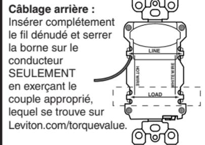
Serrer les vis sur les boucles en exerçant le couple approprié, lequel se trouve sur [Leviton.com/torquevalue](http://Leviton.com/torquevalue).
