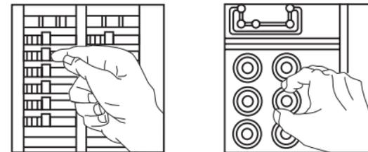
Une fois cette vérification faite, enficher le même appareil dans l'autre sortie afin de s'assurer que l'alimentation y est aussi coupée. Dans le cas contraire, on doit abandonner les travaux et faire appel à un électricien qualifié.
