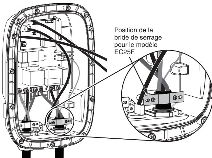
4. Réassembler les deux sections de la borne au moyen des 13 vis préalablement ôtées. Serrer ces dernières à un couple de 8,5 à 10,5 po-lb (0,96 à 1,19 N-m).
