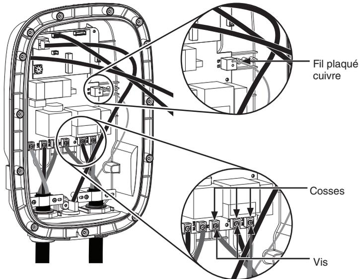
3. Serrer les deux vis de la bride à un couple de 8,5 à 10,5 po-lb (0,96 à 1,19 N-m).
