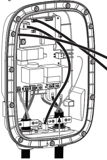
2. Connecter le fil plaqué cuivre dans la plaque de circuits. Remettre les cosses du câble en place au moyen des trois vis. Serrer ces dernières à un couple de 8,5 à 10,5 po-lb (0,96 à 1,19 N-m).
