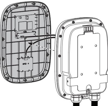
2. Retirer les trois vis et cosses du câble de la plaque de circuits. Déconnecter le fil plaqué cuivre.
