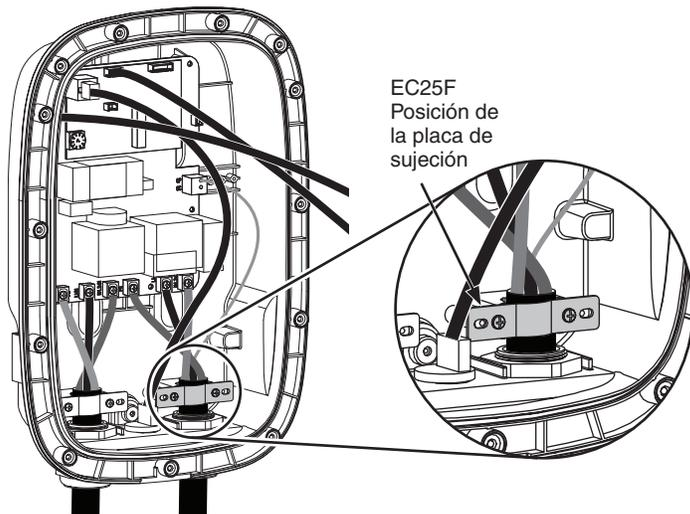
4. Instale la tapa delantera en la tapa trasera y fíjela con 13 tornillos. Apriete los tornillos a 8.5 - 10.5 pulg.-lb.
