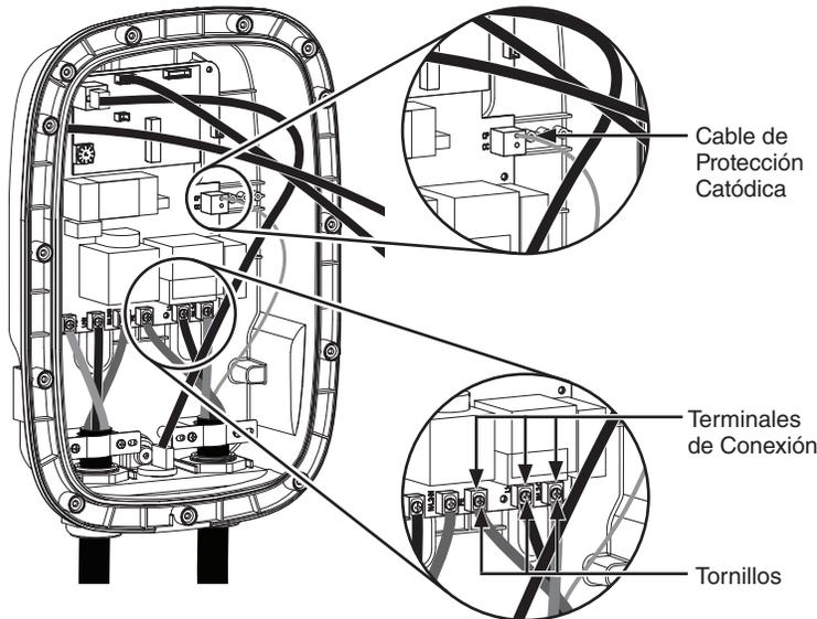
3. Apriete los dos tornillos que fijan la placa de sujeción. Torque tornillos 8.5 - 10.5 pulg.-libra.
