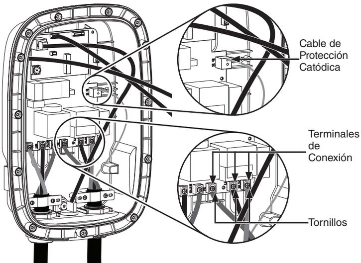
3. Afloje los dos tornillos de la placa de sujeción.
