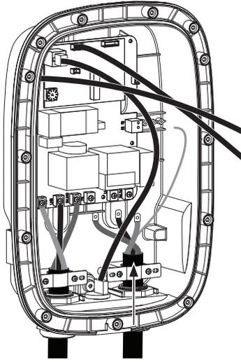
2. Conecte el cable de protección catódica a la placa de circuito. Instale las terminales de conexión del cable en la placa de circuito con tres tornillos. Apriete los tornillos a 8.5 - 10.5 pulg.-lb.
