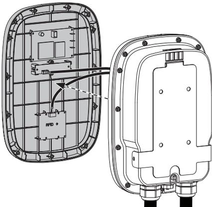
2. Retire los tres tornillos y las terminales de conexión del cable de la placa del circuito. Desconecte el cable de protección catódica.
