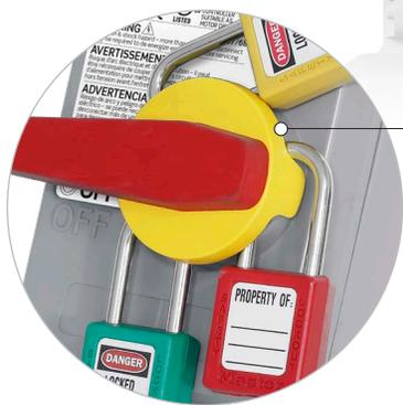
Manette pouvant être bloquée au moyen de trois cadenas, conformément aux exigences de l'OSHA en matière de verrouillage et d'étiquetage
